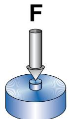
Die Speisung der Vollbrücke und Verarbeitung der Messsignale erfolgt durch einen nachgeschalteten Verstärker aus dem HAEHNE-Programm, z.B. den MV125. Die an den Ausgängen des Messverstärkers anstehenden Signale sind proportional der Druckkraft im Material und dienen zur Anzeige oder zur Verwendung als Istwert in einem geschlossenen Regelkreis.
