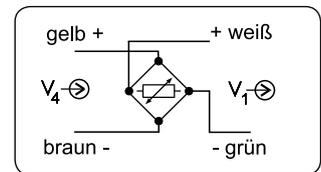
Aderfarben der Sensorleitungen bei Anschluss Variante: **N1, N2, S1, S2**
